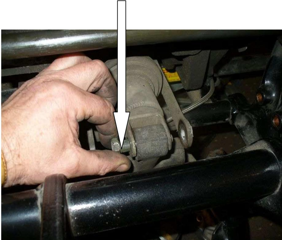
Ebenso den **Bolzen der Übertragungshebel mit Umlenkhebel** verbindet
