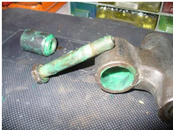
**Den Umlenkhebel in den Schraubstock gespannt und das Lager vorsichtig mit Hilfe eines kleinen Brettes und Gummihammer eingetrieben, klappte wunderbar, das Lager sitzt.**
