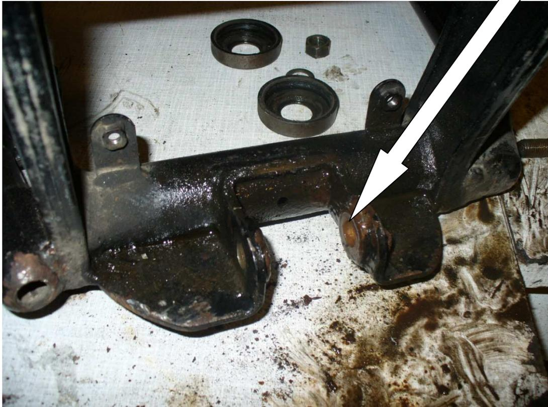
Das Lager im **Umlenkhebel (Nadellager)** hatte sich verabschiedet. Da Yamaha solche Schrauben trocken einsetzt ist durch eindringenden Schmutz und Wasser alles vergammelt
